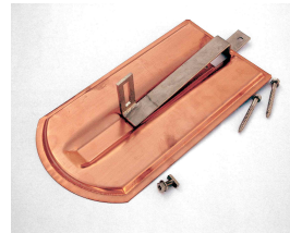
Biberschwanz-Metalldachplatte b=180 mm, h=370 mm Unterprofile senkrecht, Befestigung auf der Holzschalung
